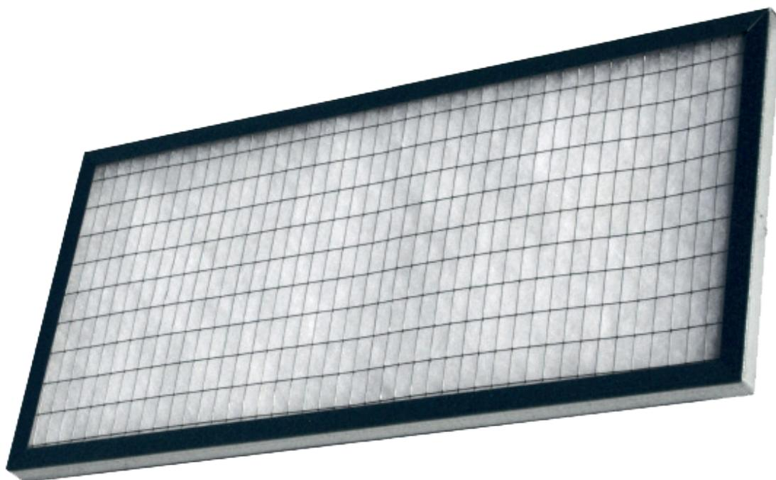
I filtri per fancoil sono personalizzati su dimensioni richieste dal cliente, con telaio e due reti elettrosaldate in mantello zincato con setto filtrante in filtrina sintetica oppure in PVC a nido d'ape lavabile.
